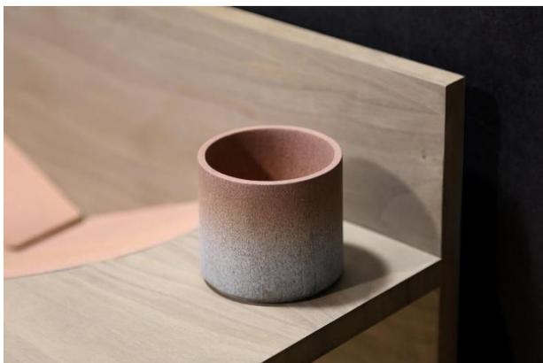
Le procédé consiste à déposer à haute vitesse et très haute température des gouttelettes de matière nanométrique en fusion sur le support bois à l'aide d'une torche cold spray ou plasma. Cette technologie
