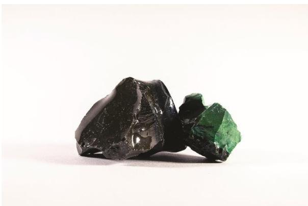
La société Inertam exploite la seule usine au monde permettant de détruire l'amiante de manière définitive et d'en valoriser le sous-produit, la Cofalit. Les déchets amiantés sont portés à très haute température jusqu'à
